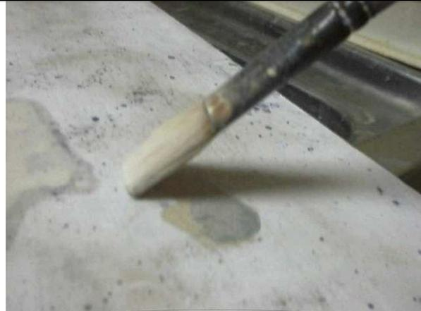
dann wird die betreffende Stelle sorgfältig mit Trennmittel bepinselt. Das Trennmittel (bitte immer nur eine kleine Menge) wird mit Wasser verdünnt bis es etwa die Konsistenz von H-Milch hat. Nach dem Auftragen kurz trocknen lassen!
