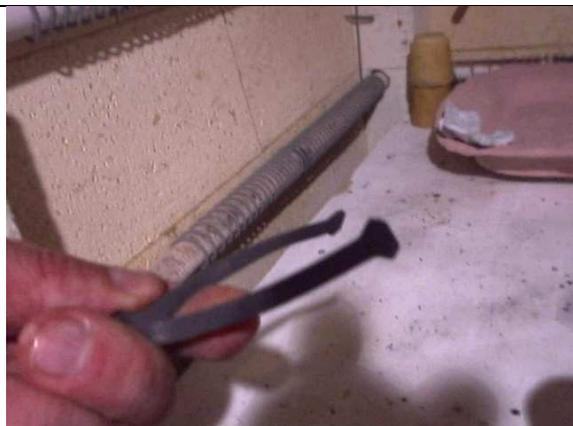
krummgebogene DreifüÙe oder DreifüÙe mit Glasuranhaftungen einfach mit der Zange behandeln, dann werden sie wieder gerade und sauber.
