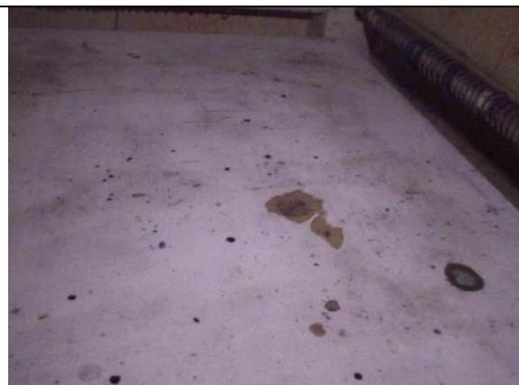
So sieht eine ungepflegte Ofenplatte aus: Mit Glasurtropfen und mit Stellen an denen das Trennmittel schon entfernt ist.
